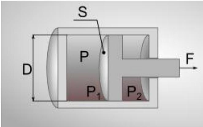
$D$  - Диаметр цилиндра;
