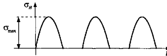
Рисунок 6.1.18 – Схема к расчету контактной прочности зуба. Цикл изменения напряжений
